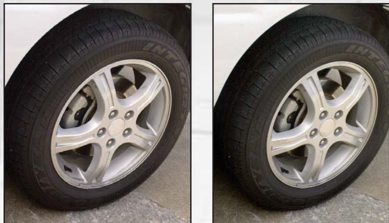
Inflado en un 70% Inflado en un 100% Puede ser muy difícil reconocer un neumático bajo en presión de aire.
