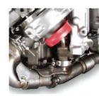
10. Loosen the exhaust inlet pipe-to-EGR cooler clamp Desserrer le collier de serrage qui unit le tuyau d'entrée des gaz d'échappement au refroidisseur du système RGE. Afloje la abrazadera que conecta la tubería de entrada de
