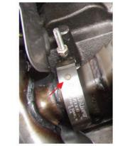
Installer les écrous qui unissent le tuyau d'admission des gaz d'échappement à la tubulure d'échappement, du côté gauche et du côté droit du moteur. Serrer les boulons alternativement de chaque côté du moteur afin de caler les tuyaux d'admission uniformément sur la bride de chacune des tubulures d'échappement.
